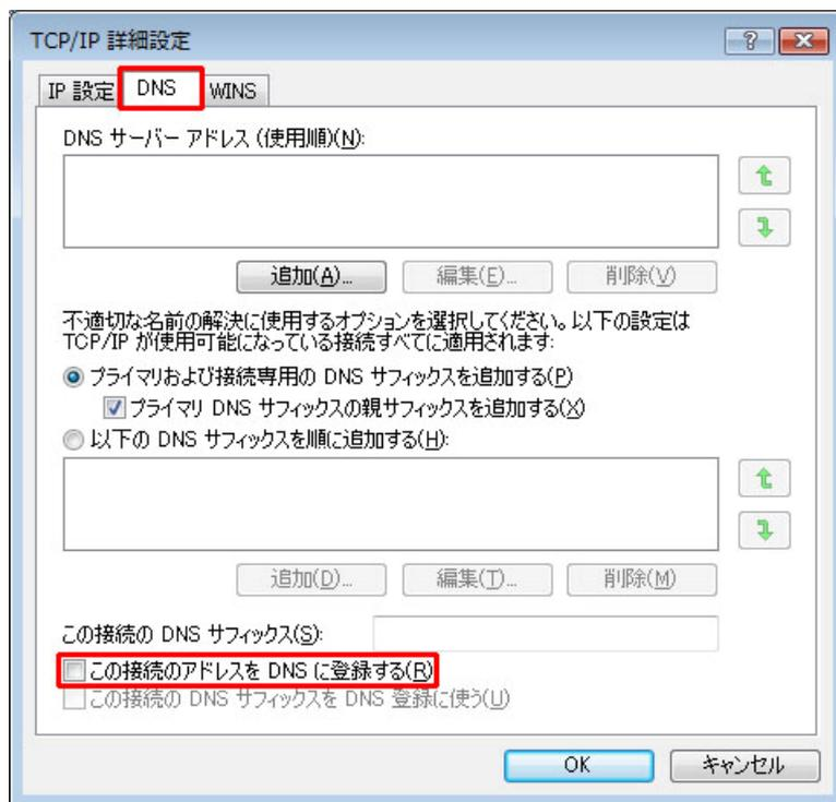
「インターネットプロトコル バージョン 4 (TCP/IPv4)のプロパティ」の「全般」で「詳細設定」ボタンをクリック。
