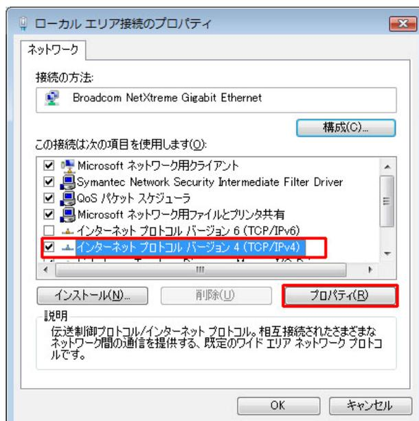
「インターネットプロトコルバージョン4 (TCP/IPv4)」を選択し、「プロパティ」ボタンをクリック。
